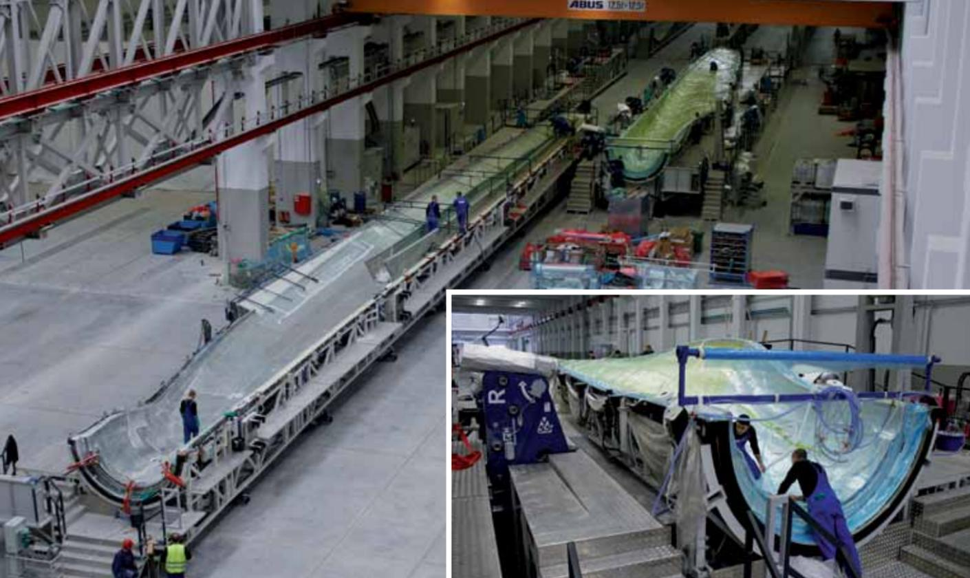
Nouveau concept dans la production des pales de rotor : les pales sont transportées sur des chariots spéciaux d'un point de la production à l'autre.
